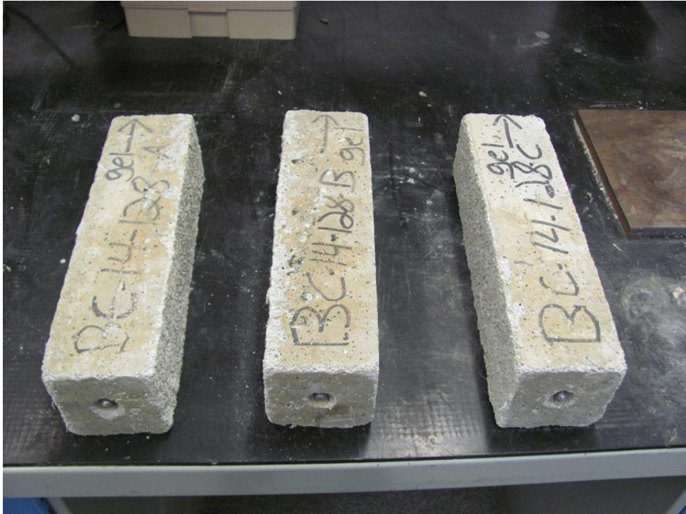
Figure 3 – Prismes de béton isolant après 300 cycles accélérés de gel-dégel
