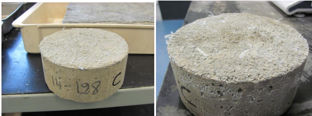
Figure 4 – État de l'échantillon C avant et après 56 cycles de gel et dégel en présence de solution saline à la surface (écaillage de surface)
